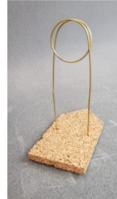
7. Stecke nun die beiden Rohrenden durch die vorgebohrten Löcher. Ziehe das Rohr nur so weit durch den Kork, dass ein Teelicht unter die Spirale passt. Dann biege das Rohr sehr vorsichtig nach hinten. Achtung! Es darf **KEIN** Knick entstehen-sonst fährt das Boot nicht!
