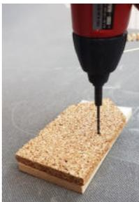
5. Lege ein Brettchen unter den Kork und bohre die beiden Löcher an der angezeichneten Stelle.
