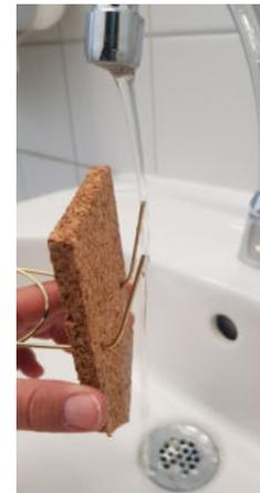
8. Fülle die beiden Röhrchen mit Wasser und setze das Boot auf's Wasser, ohne dass etwas herausläuft. Denn durch die Kerze, welche du nun unter die Spirale stellst und anzündest, wird das Wasser erhitzt, ausgestoßen und zeitgleich neues angesaugt. Und so kann sich das Boot aus eigener Kraft fortbewegen!
