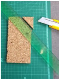
4. Dann mit Cutter und Lineal die Bootspitze abtrennen. Dafür die Schneideunterlage darunter legen.
