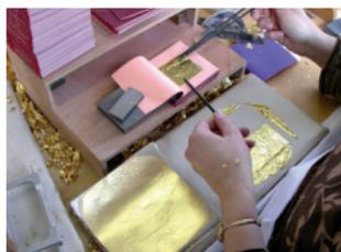
Le dernier processus de battage exige entre 5 000 et 7 000 frappes et dure entre deux heures et demie et six heures. Les marteaux spéciaux utilisés par les batteurs d'or pèsent entre 2 et 12,5 kilos. Les apprenties sont chargées de disposer les feuilles et de les couper en quatre.
