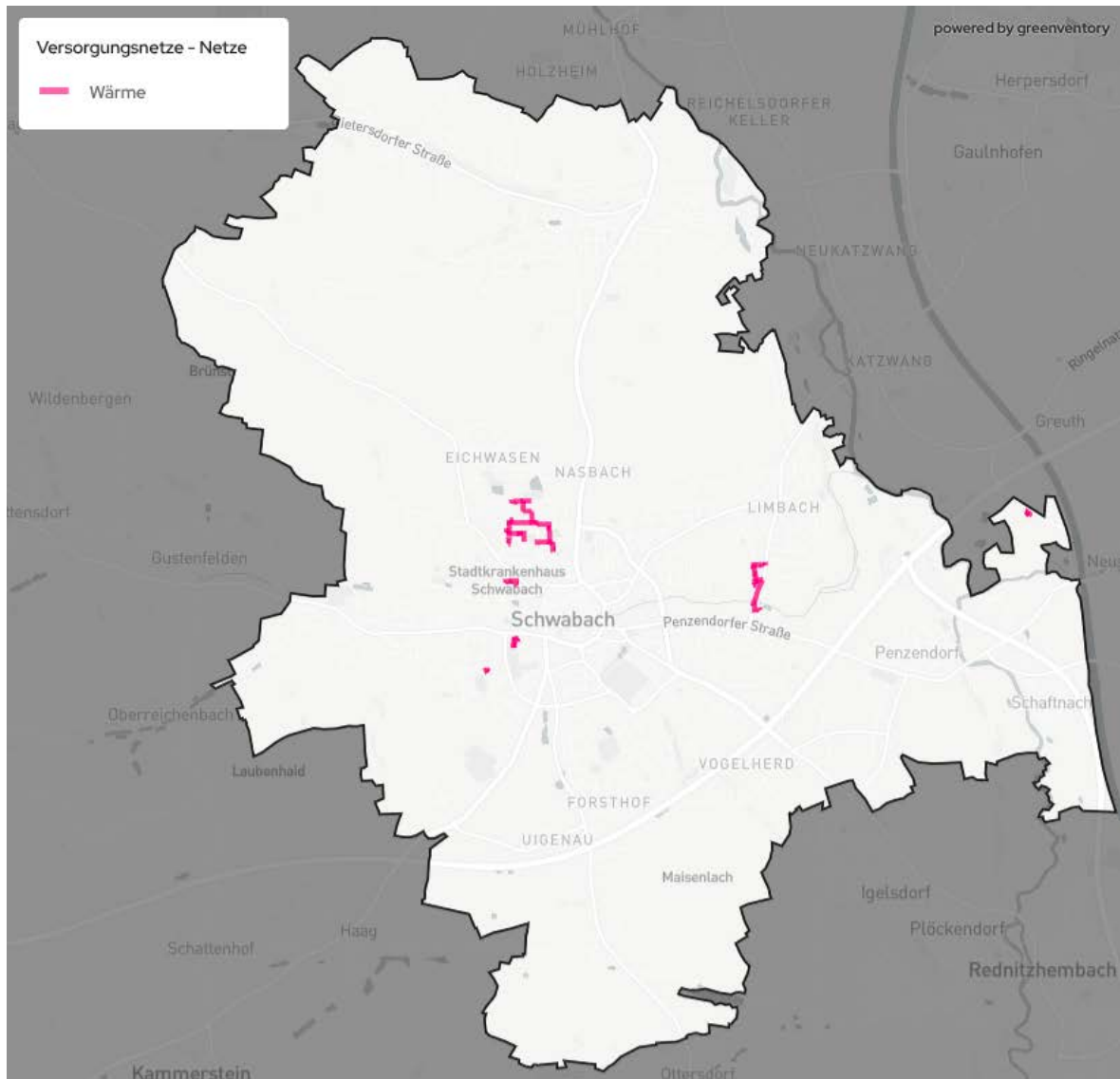
Abbildung 10: Wärmenetze in Schwabach
